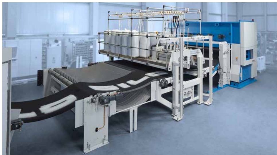
3D-Lofter“添加纺织加工系统”和新型椭圆型轨迹针刺机 DI-LOOM II SLC HaV35
