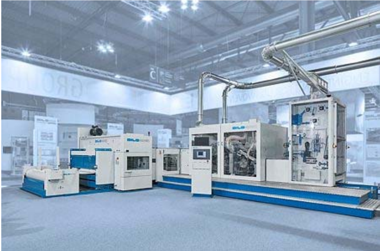
Dilo-Kompaktanlage zur Vernadelung von Carbonfasern
